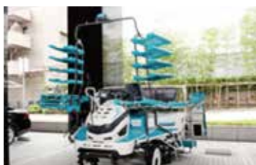
自動操舵田植機(頭上にGPSのアンテナがある)
