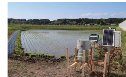
ICT(情報通信技術)を活用した農業用水の遠隔監視システム
